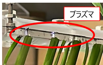
図 8 刃とソルガム間に発生するプラズマ Plasma generated between blade and sorghum
